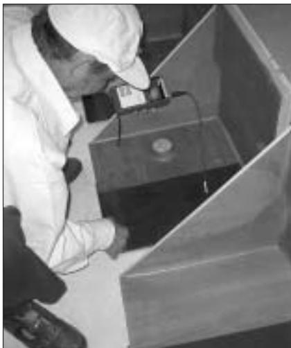
写真3 検査1 膜厚検査
