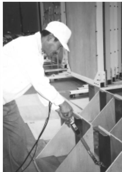
写真2: 検定員によるピンホール検査
